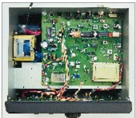
Ein Blick ins Innere des DX-394. Es bietet genügend Platz für eventuelle Modifikationen. Das Netzteil ist bereits eingebaut. Auch eine Ferritantenne für Lang- und Mittelwelle ist vorhanden, die jedoch bei Anschluß einer Außenantenne ihre Richtwirkung verliert.
